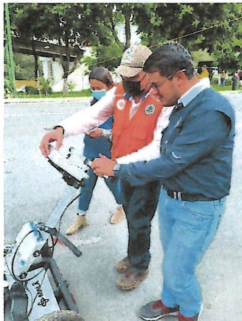
Fotografías 15 y 16. Escaneo de las áreas de interés, utilizando un radar de penetración de suelo (GPR por sus siglas en inglés)
